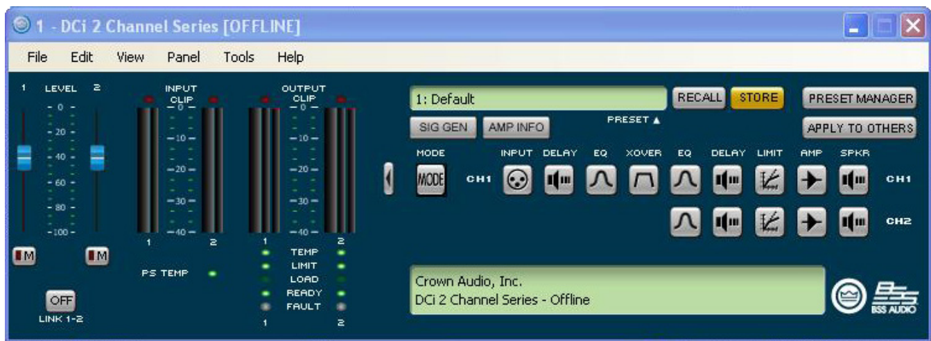
图 17 选中“Y 1+2”框时，输出 Ch.1 和 Ch.2 均由输入 Ch.1 馈送，而输入处理也照此安排。
