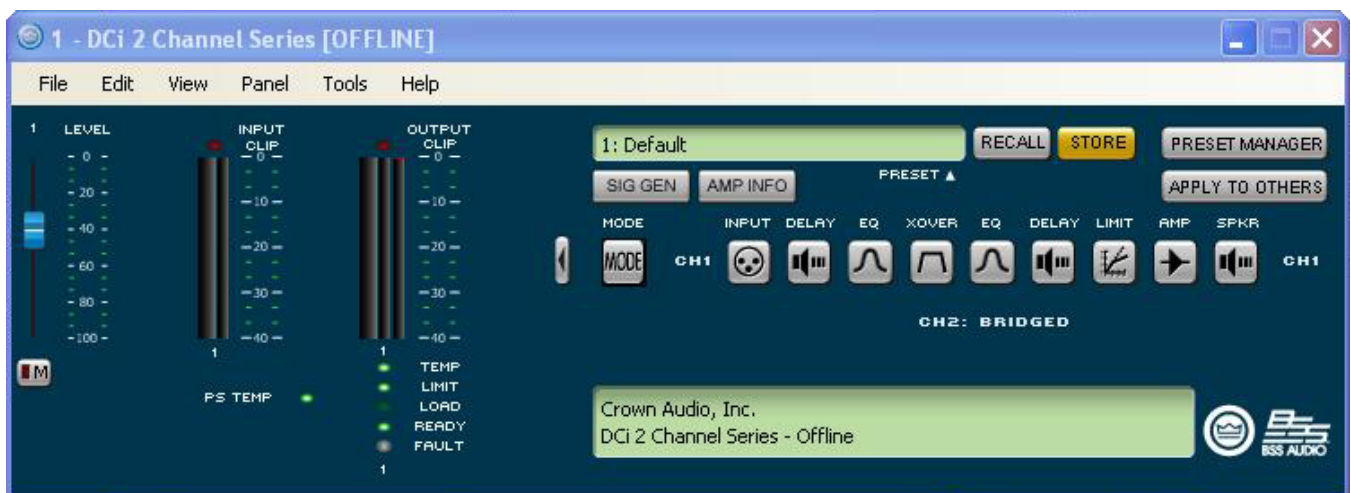
图 19 通过选择单声道桥接输出，声道对 DSP 中只有一个声道可供使用。
