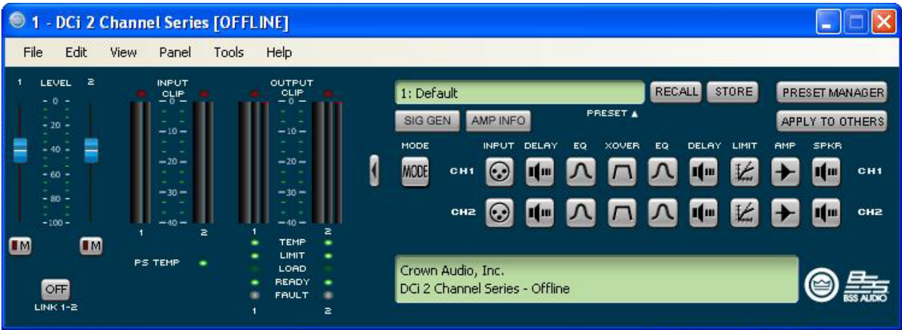
图 14（上）显示了 DriveCore Install 的 2 声道配置页面。4 和 8 声道放大器配置页面包含相同的功能集。DriveCore Install Network 放大器包括数字信号处理 (DSP)、多个输入/输出路由选项以及综合诊断功能集。所有这些功能均可通过配置页面进行调整。
